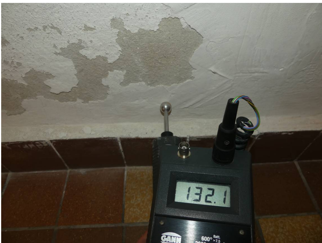
Foto 7 – Měření příložným vlhkoměrem v místě zvýšené vlhkosti zdiva
