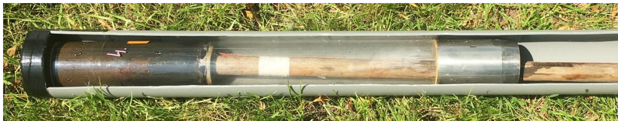
Obrázek 3. Na fotografii je vidět plexisklová trubice s odebraným sedimentem, již s vytlačnou vodou nad sedimentem, umístěná v plastovém korýtku. Sediment je zafixován v horní pozici plexisklové trubice, a současně v korýtku, dřevěnou tyčí. V dalším kroku následuje „svlečení“ plexisklové trubice ze sedimentu ve směru aretační dřevěné tyče pro následné fotografování a popis kvality.
