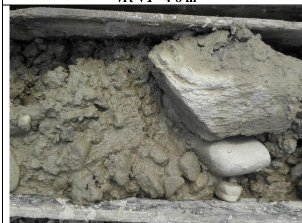
V1 - detail zvodnělých, fluviálních štěrkopísků
